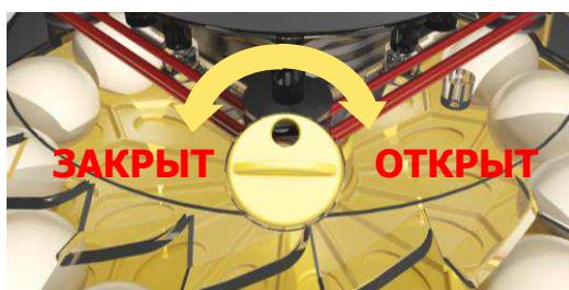
Открывание и закрывание душника: Чтобы повысить влажность, закройте душник; чтобы понизить влажность, откройте душник.
